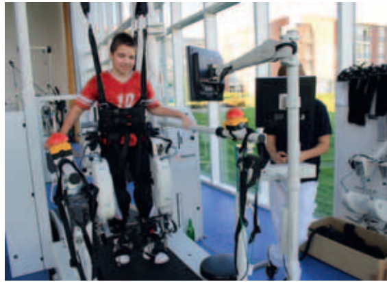
Abb. 2: Der Lokomat® ist ein Exoskelett-Motor-System, das gleichmäßige Gehbewegungen repetitiv und mit oder ohne Belastung durchführt. So ist ein intensives Gangtraining möglich.
